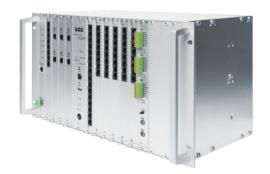
Der Kommunikationsserver COMmander 6000RX wird von der kleinsten Ausbaustufe bis zum Vollausbau individuell nach Ihrem Bedarf konzipiert. 38 Amtkanäle und bis zu 112 interne Ports sind realisierbar. Für die Verbindung mit dem öffentlichen Telefonnetz stehen VoIP-Amtkanäle, ISDN-Basisanschlüsse und ein S<sub>2M</sub>-Primärmultiplexanschluss zur Auswahl, während die internen Teilnehmer sich die VoIP-, ISDN- und Analog-Anschlüsse teilen.
